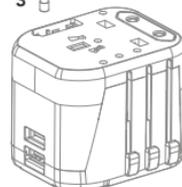
**Pour remplacer le fusible :** Retirer le couvercle du fusible (1). Retirer l'ancien fusible (2). Le remplacer par le fusible de rechange fourni (3).
