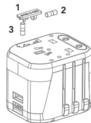
**Para reemplazar el fusible:** Extraiga la tapa del fusible (1). Extraiga el fusible antiguo (2). Reemplace con el fusible de repuesto incluido (3).
